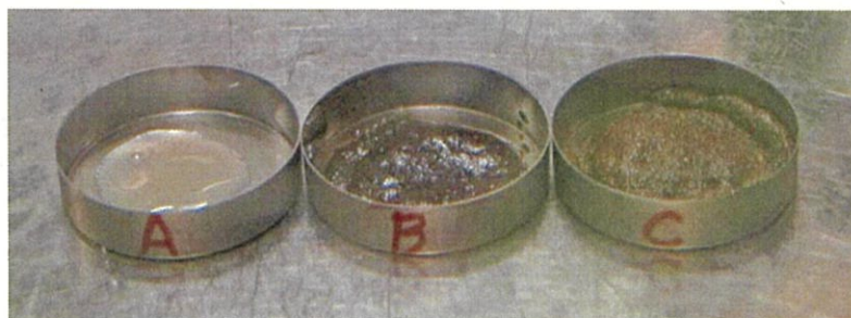
図②-4 密閉容器から取り出した試料C(右端)と解放状態にあった試料A、Bの比較
