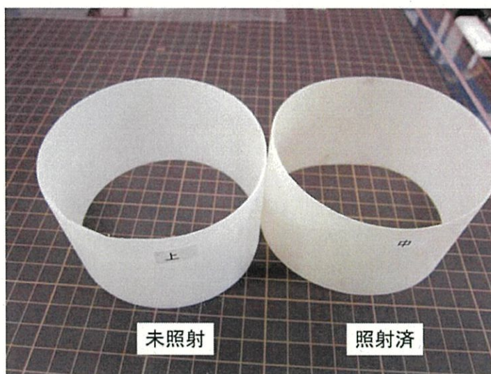
図⑱-1 非照射と照射後のポリ容器の外観観察結果
